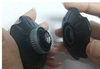
4.使用碟型扳手 逆时针旋转
