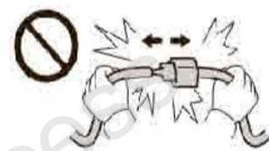
拆卸接线器、端子之类的接线时,请不要用力拉拽线束。
