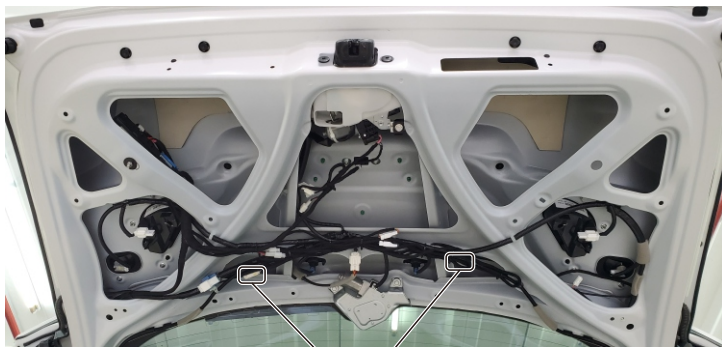
43. 左右两边防夹条线束插头对接。
